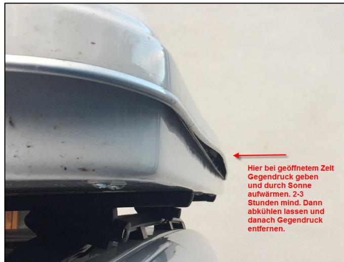
Ganz wichtig: beim Schliessen jedesmal auf beiden Seiten mit Kontrollblick sicher stellen, dass die Oberschale genau auf die Unterschale schliesst.
